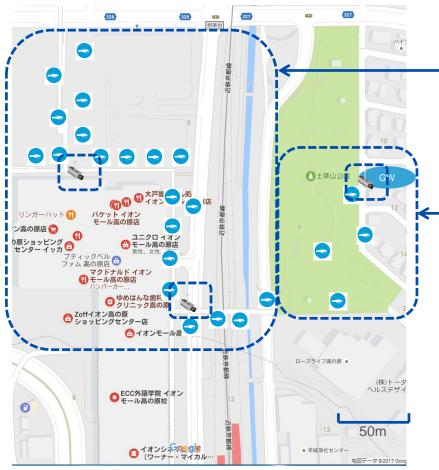
遊歩道ゾーン(CDF):街灯20本 点灯時間:○時~○時 調光:CD・・・100W代替LEDランプ(30W)の調光コントロール F・・・200W代替LEDランプ(50W)の調光コントロール
